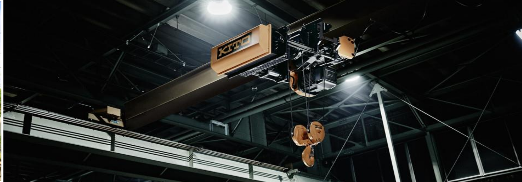
マテリアルハンドリングプラットフォームとしてのホイストとブドウ棚鉄骨
